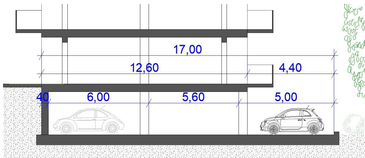
Secțiune parcare demisol
